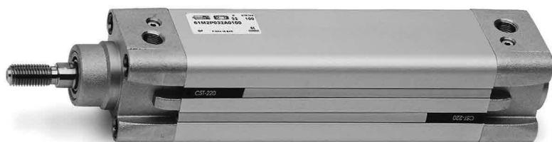
Los cilindros serie 61 han sido diseñados para cumplir con las dimensiones establecidas en los estándares del ISO 15552. Sobre el perfil de aluminio existen dos ranuras, disponibles en tres lados del perfil, donde es posible montar directamente el sensor de proximidad para la detección de la posición del pistón. Esta ranura se puede cubrir con un perfil.
